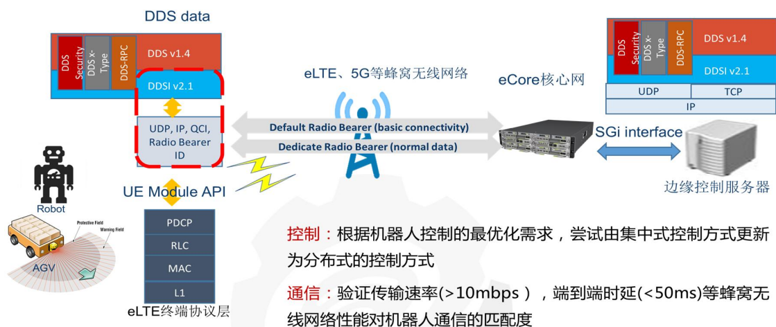
图 3：测试床软件平台及接口协议
