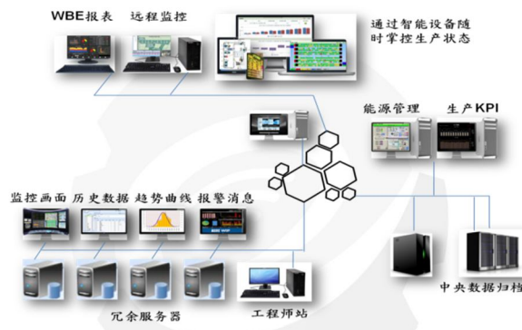
图 14 SCADA 系统（换图）
